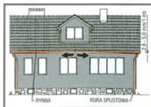
Rys. 10. Sposób zamontowania rynny z dwoma odpływami
