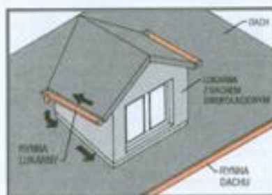
Rys. 6. Nieprawidłowy system rynnowy lukarny
