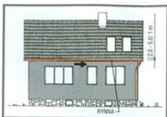
Rys. 9. Sposób zamontowania rynny z jednym odpływem
